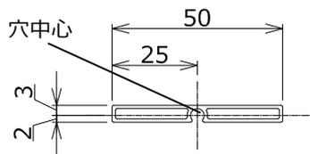
※ すきま材の貼付け、バー材の下穴加工を行ったバー材を使用してフェンス本体の取付を行います。これ以降の取付は、フェンス本体の取付説明書P9「3-1 バー材仕様の板本体取付方法」を参照してください。
