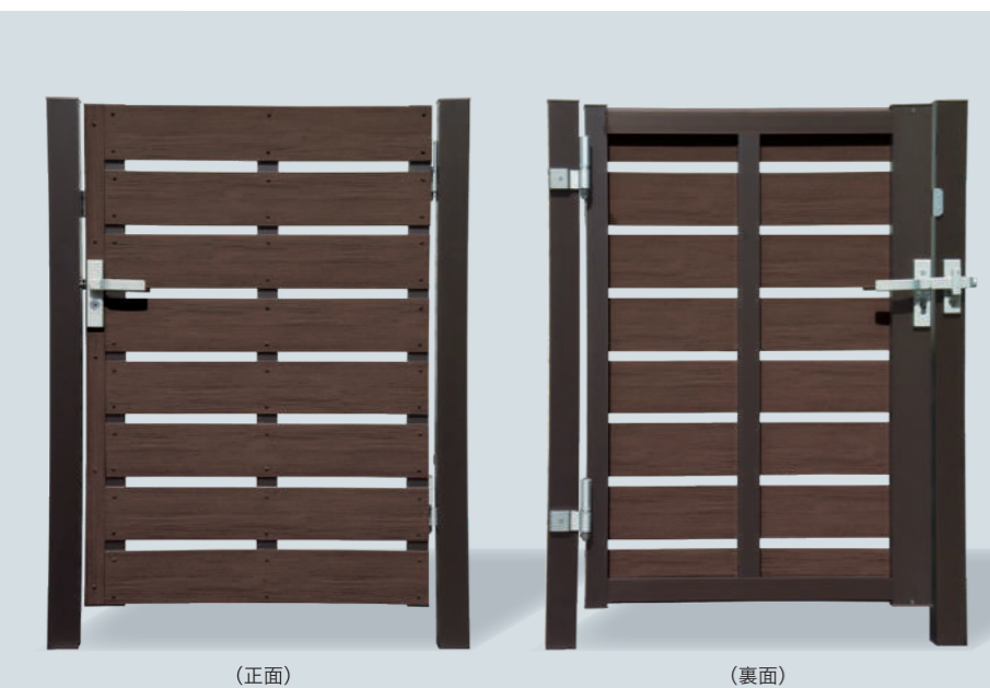
W08 8段 隙間20mm(T-12) ルイボス 内開き 右吊元 ※板幅は120mmサイズ ※写真は右吊元、PS板を施工現場で取付けることにより施工現場で左右吊元変更が可能。※PS板のサイズと隙間を選択ください。 ※錠について:シリンドー錠(家側はサムターン仕様)
